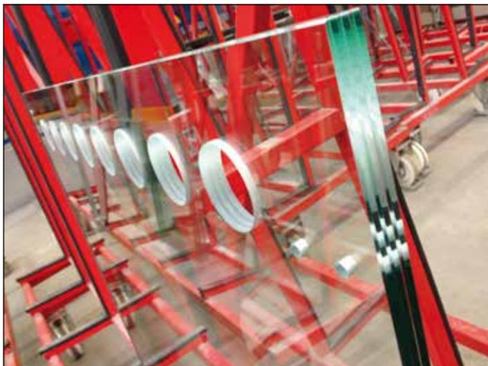
Sicherheitsgläser mit Lochbohrungen für perfekte Anwendungen (Foto: Sicherheitsglas-technik Oelsnitz (Vogtl.) GmbH)
