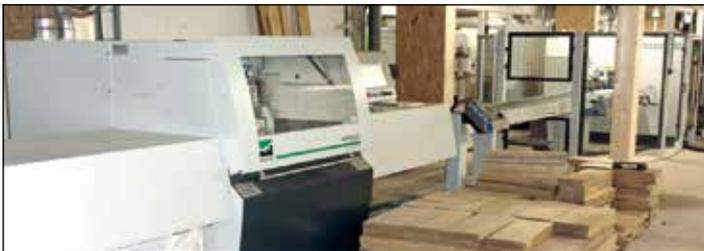
Die Weinig-Kapplinie mit der Optimierungskapplanlage OptiCut 260 und dem EasyScan Smart-Scanner (Foto: Philipp Matzku/holzkurier.com)
